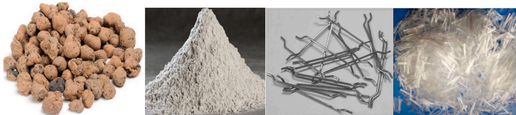
Fig. 1. (a) LECA (b) GGBFS (c) hooked end steel fibre (d) Polypropylene Fibre.
